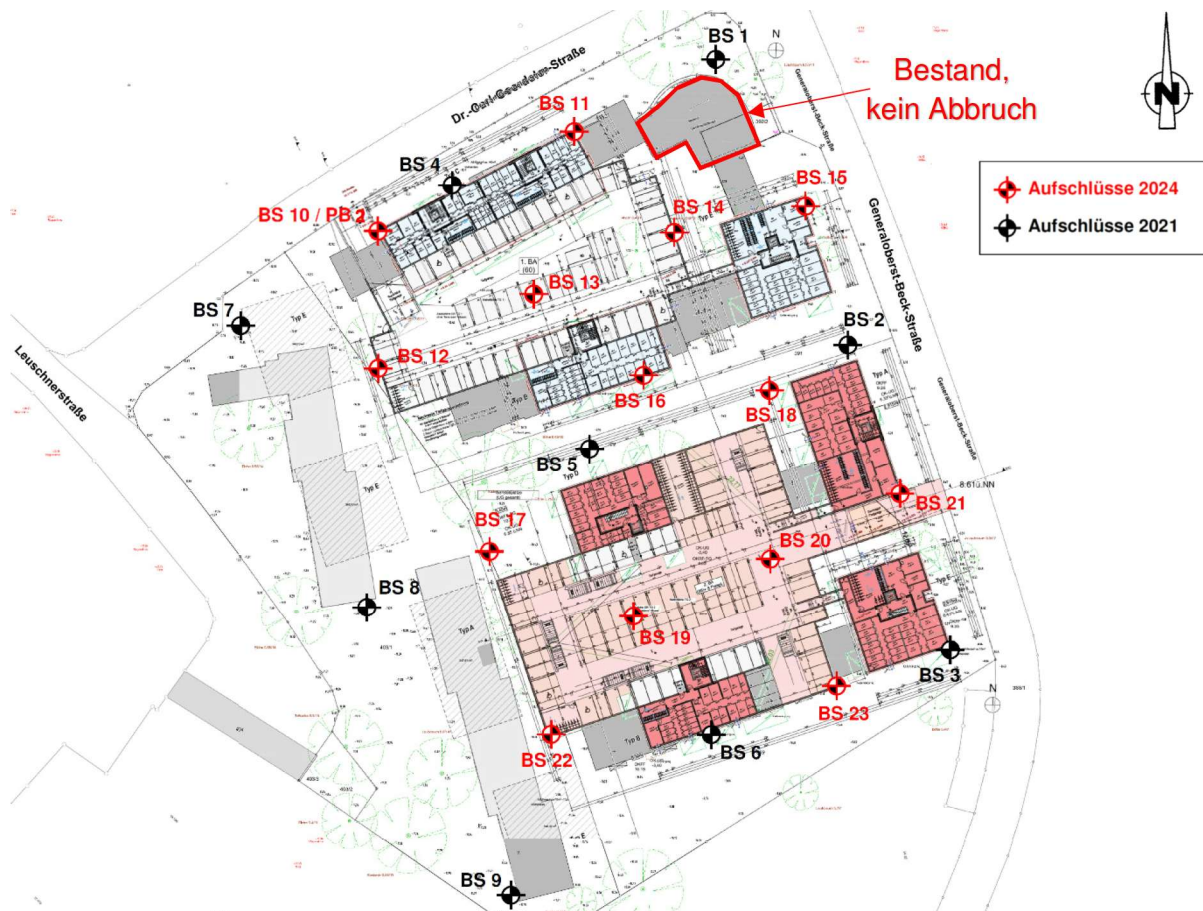
Abbildung 9 - Lageplan der Baugrundaufschlüsse
